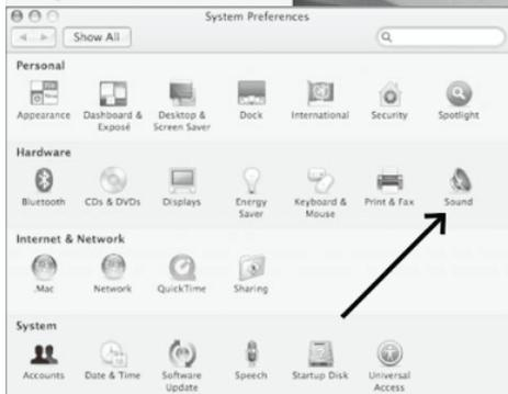
3. Затем кликните вкладку "Звук", чтобы открыть панель звука.
