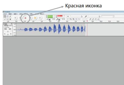
4. При начале записи источник звука должен быть направлен в сторону микрофона, на которой напечатано «Alctron».
