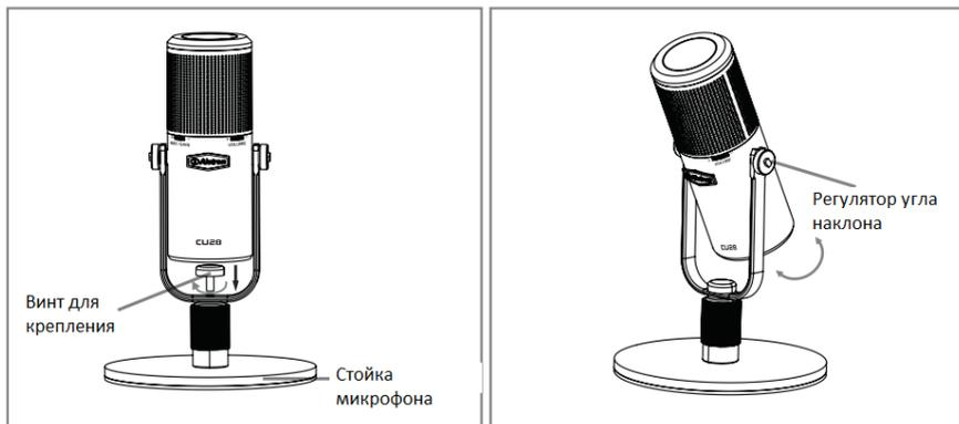
Установите микрофон на стойку для микрофона и прикрутите винтом.
