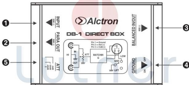
①+② INPUT/PARA OUT (1/4"TS): эти разъемы используются для подключения небалансных источников сигнала. Поскольку оба разъема подключены параллельно, они могут использоваться как в качестве входа, так и в качестве прямого выхода для передачи сигнала на усилитель монитора.
