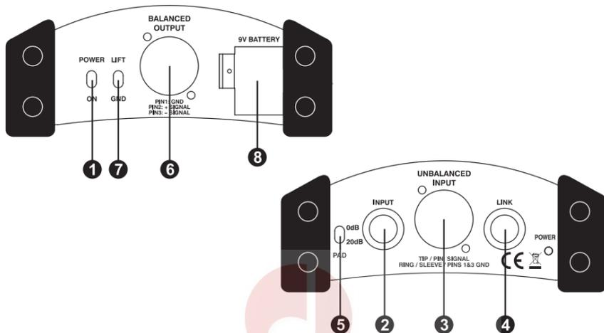
**1. ON/POWER:** выключатель питания. Вы можете включать и выключать аккумулятор, чтобы продлить срок его службы. При выключенном питании DI100 перестанет работать. При включении DI100 автоматически переключается между батареями и фантомным питанием. Когда DI100 работает от батареи, светодиод POWER будет мигать каждые несколько секунд, а при работе с фантомным светодиодом POWER будет гореть постоянно.
