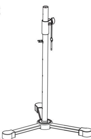
Вставьте ножки (С) в основание подставки (совместив отверстия), вставьте длинные шестигранные болты с гайками (Е) в основание подставки, зафиксируйте ножки с помощью гаечного ключа (G).
