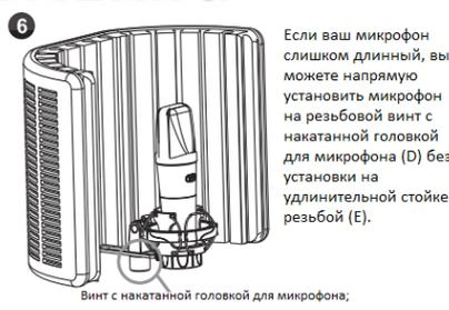
Если ваш микрофон слишком длинный, вы можете напрямую установить микрофон на резьбовой винт с накатанной головкой для микрофона (D) без установки на удлинительной стойке с резьбой (E).
