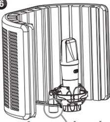
Если ваш микрофон слишком длинный, вы можете напрямую установить микрофон на резьбовой винт с накатанной головкой для микрофона (D) без установки на удлинительной стойке с резьбой (E).
