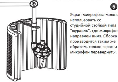
Экран микрофона можно использовать со студийной стойкой типа "журавль", где микрофон направлен вниз. Сборка производится таким же образом, только экран и микрофон перевернуты.
