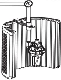
Экран микрофона можно использовать со студийной стойкой типа "журавль", где микрофон направлен вниз. Сборка производится таким же образом, только экран и микрофон перевернуты.
