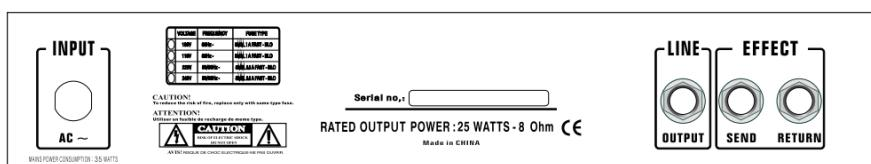
**ЛИНЕЙНЫЙ ВЫХОД / LINE OUTPUT** – для подключения к внешнему усилителю.
