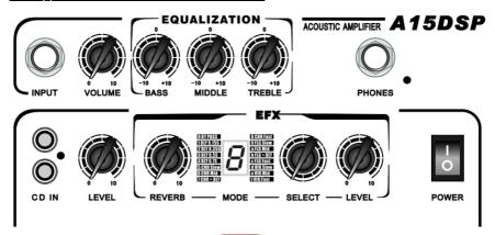
ВХОД / INPUT – входы для подключения инструмента.
