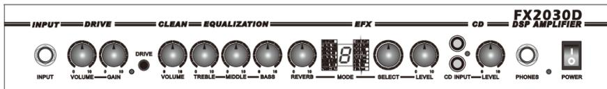
ВХОД / INPUT – вход для подключения гитары.
