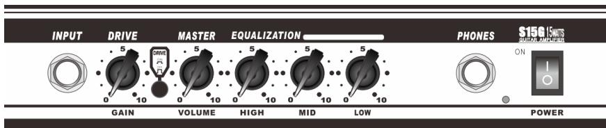
**ВХОД / INPUT** – для подключения гитары.
