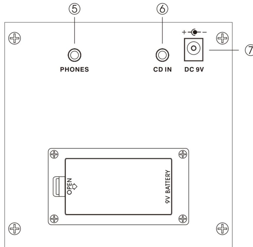
5. Разъем PHONES – разъем подключения наушников. При подключении наушников встроенный динамик комбо-усилителя отключается.
