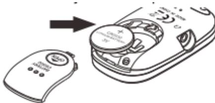
Поверните тюнер WST-2046 WZ как показано на рисунке. Откройте крышку отсека элементов питания. Извлеките батарейку, вставьте новую, соблюдая полярность. Закройте крышку отсека элементов питания.
