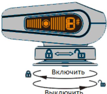
Прикрепите тюнер ST-710 к поверхности инструмента, поверните тюнер на 90 градусов по часовой стрелке, чтобы включить его. Чтобы выключить тюнер, поверните его на 90 градусов против часовой стрелки.
