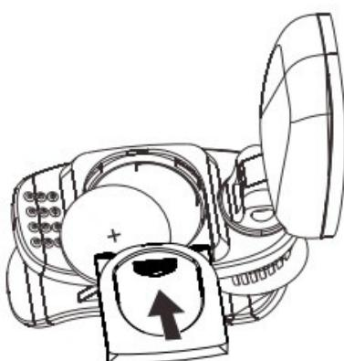
Поверните тюнер WST-630C как показано на рисунке. Откройте крышку отсека элементов питания. Извлеките батарейку, вставьте новую, соблюдая полярность. Закройте крышку отсека элементов питания.
