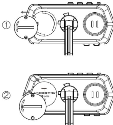
1. Вращайте крышку отсека батарей, пока она не откроется. Выньте батарею, замените на новую и закрепите крышку отсека до щелчка. Обращайте внимание на полярность.
