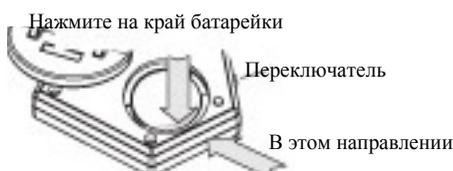
После открытия крышки нажмите на край батарейки, в направлении, которое показано на рисунке выше. Батарейка автоматически приподнимется из отсека.
