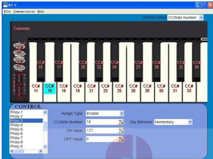
Двадцать одна клавиша клавиатуры будут функционировать как независимые кнопки для передачи сообщений об изменении управления. Вы можете указать, по какому MIDI-каналу передается сообщение об изменении элемента управления, включена ли каждая клавиша, тип ключа, номер изменения элемента управления, а также значение On и Off.
