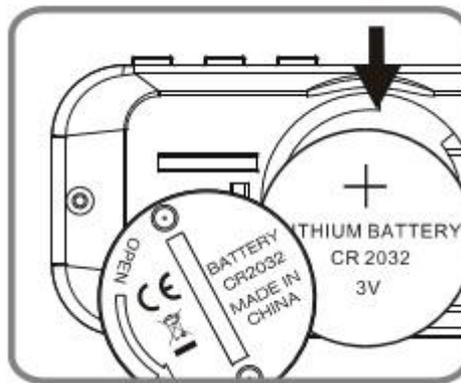
Переверните тюнер T-91RC дисплеем вниз. Откройте крышку отсека элементов питания. Извлеките батарейку, вставьте новую, соблюдая полярность. Закройте крышку отсека элементов питания.
