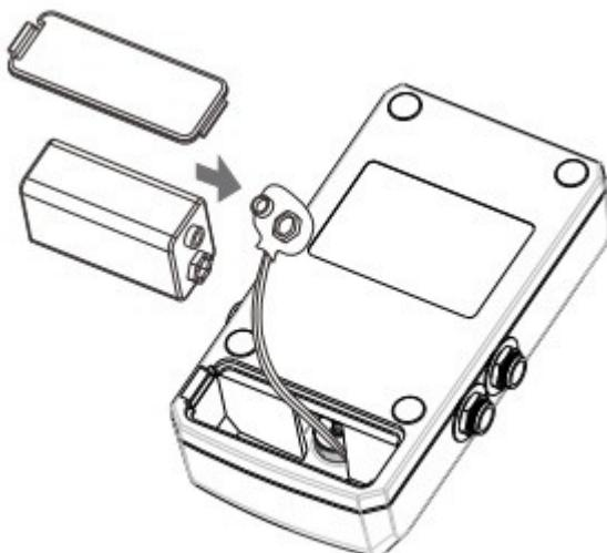
В качестве элемента питания используется батарейка 9V ("крона"). Переверните CHORUS CORE дисплеем вниз. Откройте крышку отсека элемента питания. Извлеките старую батарейку, вставьте новую, соблюдая полярность. Закройте крышку отсека элемента питания.
