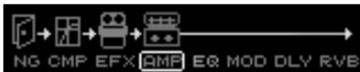
Нажимая кнопки **GROUP/MODULE**, выберите модуль эффектов, который нужно отредактировать. Вращая регулятор **SELECT**, выберите нужный эффект в модуле эффектов. Используя регулятор **PARAMETERS**, установите нужное значение для эффекта.
