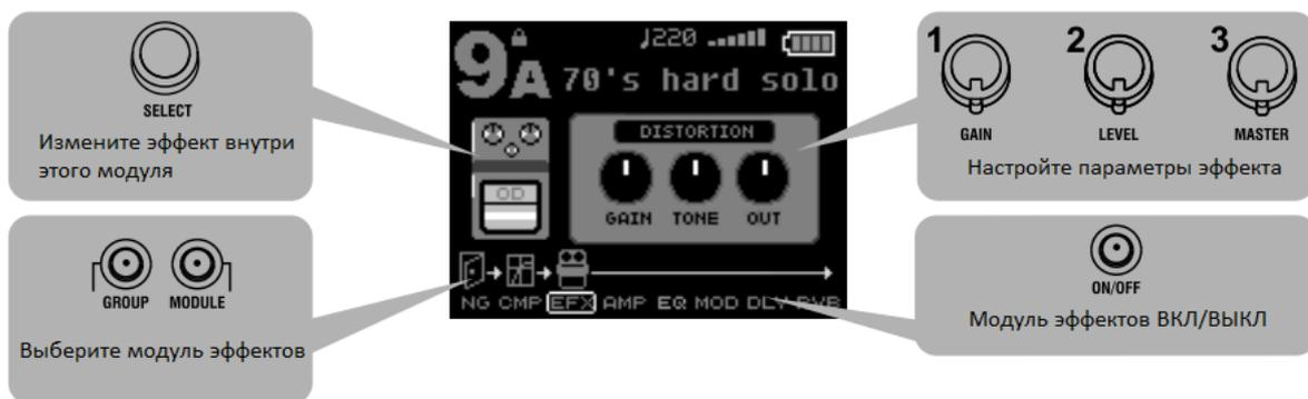
Нажмите кнопку **ON/OFF**, чтобы быстро включить или выключить выбранный модуль эффектов. Выключенный модуль пропускает звук через себя без изменений и исчезает из сигнальной цепи на нижней части дисплея.
