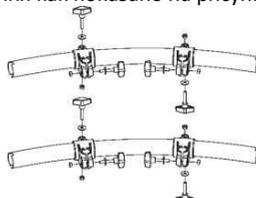
6. Соедините передние стойки и боковые крепления. Пожалуйста, убедитесь, что боковое крепление зафиксировано в зажиме шарнира.
