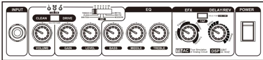
ВХОД / INPUT: Гнездо подключения электрогитары.
