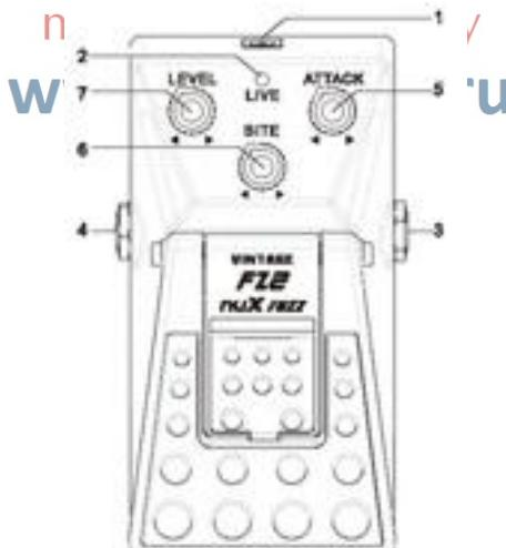
1. Гнездо подключения сетевого адаптера (сетевой адаптер – это устройство, преобразующее и стабилизирующее сетевое напряжение в 9V, пожалуйста, соблюдайте полярность).
