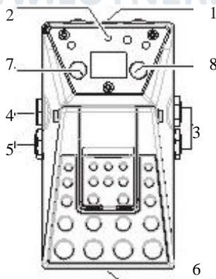
1. Гнездо подключения сетевого адаптера (сетевой адаптер – это устройство, преобразующее и стабилизирующее сетевое напряжение в 9V, пожалуйста, соблюдайте полярность).
