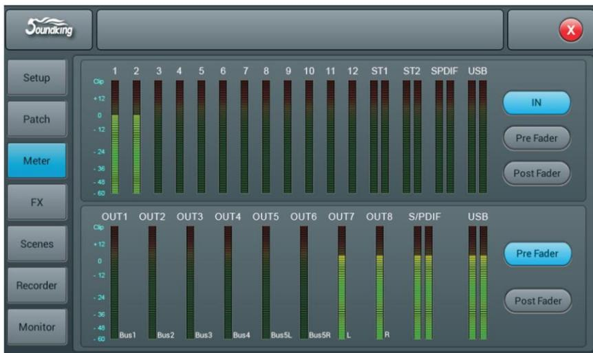
Уровень сигнала канала обработки ввода имеет три режима: IN, Pre Fader и Post Fader, по умолчанию установлен Pre Fader. Вы можете выбрать режим уровня сигнала, который будет отображаться одним нажатием кнопки. Уровень сигнала на выходе имеет два режима Pre Fader и Post Fader, по умолчанию Pre Fader. Вы можете выбрать режим уровня сигнала, который будет отображаться одним нажатием кнопки. Справа от уровня сигнала выходов вы можете видеть названия шин, которые назначены порту.
