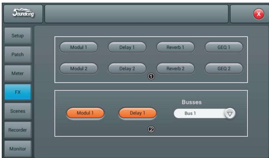
Эффекты имеют 8 модулей: 2 модуляции, 2 задержки, 2 реверберации и 2 15-полосных графических эквалайзера. Все модули могут быть вставлены в канал обработки ввода или канал обработки шины, но только один раз. Обратите внимание, что канал обработки ввода может быть вставлен только с одним модулем эффектов, тогда как шина может иметь два модуля.
