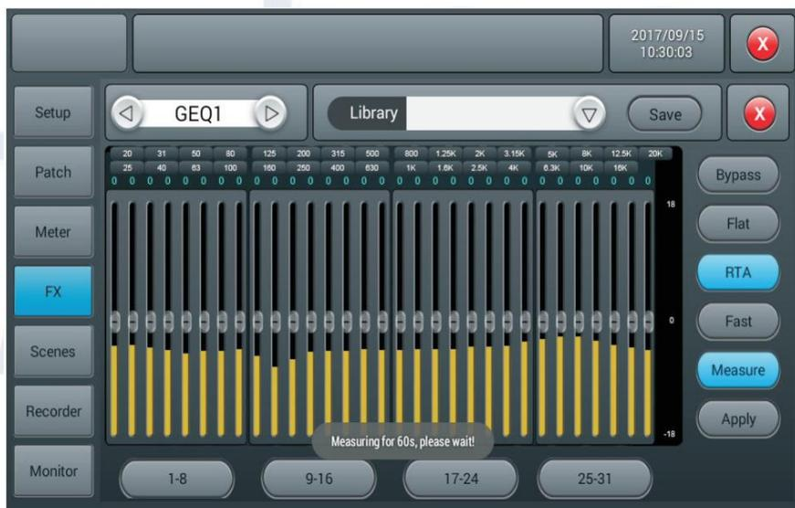
Когда измерение закончено, кнопка измерения погаснет. Теперь закройте диалог GEQ и вставьте GEQ в шину LR либо на странице эффектов, либо в секции ввода шины LR. Затем вернитесь к GEQ, отпустите мастер-фейдер и нажмите "Применить", что приведет к изменению ваших фейдеров для выравнивания в соответствии с последним измерением.
