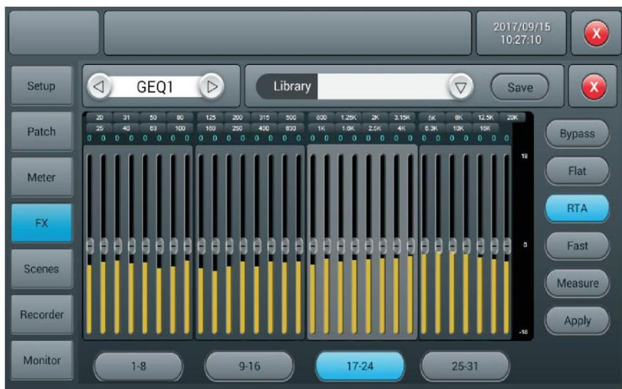
Теперь нажмите измерение, и появится диалог, указывающий, что устройство начнет измерение в течение 60 секунд. Пожалуйста, не прикасайтесь ни к одному из фейдеров или регуляторов во время процесса измерения, так как это может существенно повлиять на результат.
