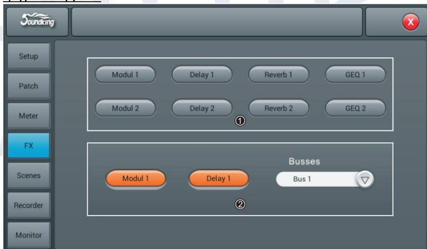
Страница Эффекты содержит 8 модулей: 2 эффекта модуляции, 2 задержки, 2 реверберации и 2 15-полосный графических эквалайзера. Все модули могут быть
