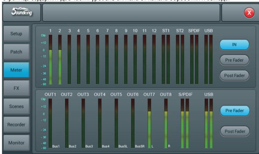
Уровень сигнала канала обработки ввода имеет три режима: IN, PreFader и PostFader, значение по умолчанию PreFader. Нажмите кнопку, чтобы выбрать режим уровня сигнала, который будет отображаться. Уровень сигнала на выходе имеет два режима: PreFader и PostFader, значение по умолчанию PreFader. Нажмите кнопку, чтобы выбрать режим уровня сигнала, который будет отображаться. С правой стороны от уровня сигнала вы можете увидеть имена шин, которые назначены порту.
