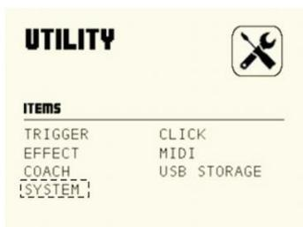
В интерфейсе UTILITY с помощью кнопок курсора выберите SYSTEM, затем нажмите кнопку [ENTER], чтобы войти в интерфейс системных настроек.
