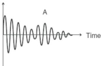
Это происходит, в частности, на затухающей границе формы волны. Функция Retrigger Cancel обнаруживает такое искажение и предотвращает повторное включение.
