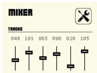
С. После использования кнопки **[SELECT]**, фейдер не переместится в положение, соответствующее установленной громкости, вы должны немного подвигать фейдер;
