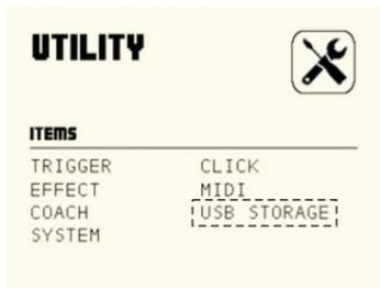
C. В интерфейсе UTILITY с помощью кнопок курсора выберите USB STORAGE, затем нажмите кнопку **[ENTER]**, чтобы войти в интерфейс настройки USB.
