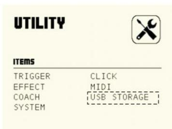
2). В интерфейсе UTILITY с помощью кнопок курсора выберите USB STORAGE, затем нажмите кнопку [ENTER], чтобы войти в интерфейс настройки USB.
